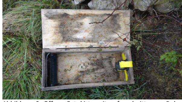
Abbildung 6. Offene Fotokiste mit aufgeschnittenem Rohr und Massstab auf der linken Seite und festgeklebter Kamera auf der rechten Seite.
