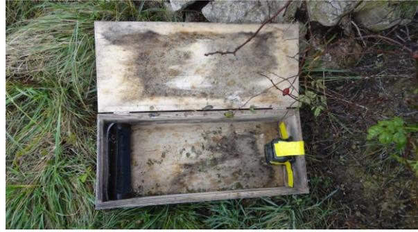
Abbildung 6. Offene Fotokiste mit aufgeschnittenem Rohr und Massstab auf der linken Seite und festgeklebter Kamera auf der rechten Seite.
