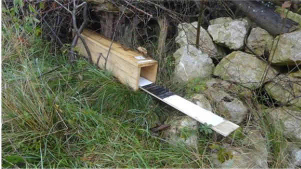
Abbildung 5. Spurentunnel mit halb herausgezogenem Laufbrettchen und darauf liegendem Spurenpapier.
